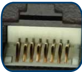
高低触点设计可以改善传输性能
